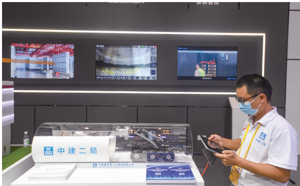
8月22日,工作人员在2022智博会重庆馆操控、演示智能管道检测机器人。
