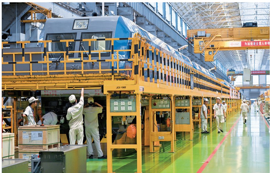
2024年7月26日，中车株机公司工作人员在总装车间组装大功率电力机车。
