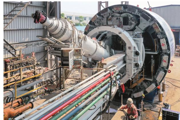
8月27日,施工人员在整备一台经过再制造的大直径盾构机的管线设备。这台2010年出厂的盾构机已到期报废,经过设备再制造,性能还得到进一步提升。用于隧道掘进的盾构机凭借“铁齿钢牙”可以“咬碎”坚硬岩石,但相应损耗也大,设备需要经常维保和换装。中国铁建华南盾构基地由中铁十八局组建运营,是一家专门从事盾构全产业链服务的“4S”店。近三年以来,已为大湾区提供近60套盾构设备的维保、再制造、新机组装、检测联调服务及一系列盾构相关产品。经设备再制造的旧零部件可实现循环利用,并减少有害气体的排放。
